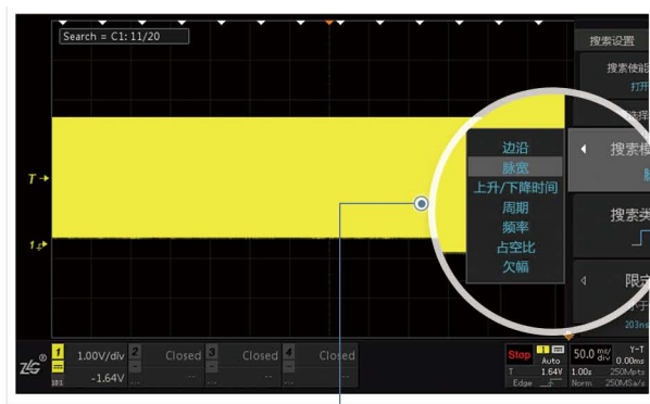
设置搜索条件，支持边沿、脉宽、欠幅、上升/下降时间、周期/频率多种搜索条件
