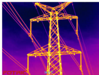
使用L07-236广角镜头测试50米远高压塔线夹
